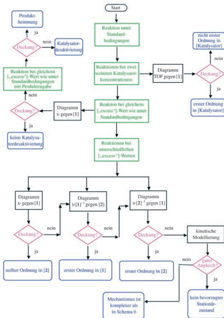
Schema 10. Flussdiagramm für die kinetische Analyse einer katalytischen Reaktion mit zwei Substraten. Grüne Kästchen markieren Experimente, schwarze die zugehörigen Auswertungsschritte. An den durch rote Rauten gekennzeichneten Punkten muss überprüft werden, ob überlagerte Kurven vorliegen.
